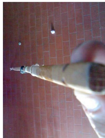
Nel caso di un arco "storto", se non si può riportarlo dal costruttore, il metodo per rimetterlo in "dima" è sempre il riscaldamento a vapore per 30-40 min, poi con cautela utilizzando stracci per non scottarsi e rovinare la superficie del legno, applicare una forza contrapposta alla curva per alcuni minuti (se possibile fino al raffreddamento del legno) dopodiché ungere nuovamente l'arco con olio di lino o i soliti grassi già normalmente utilizzati.
